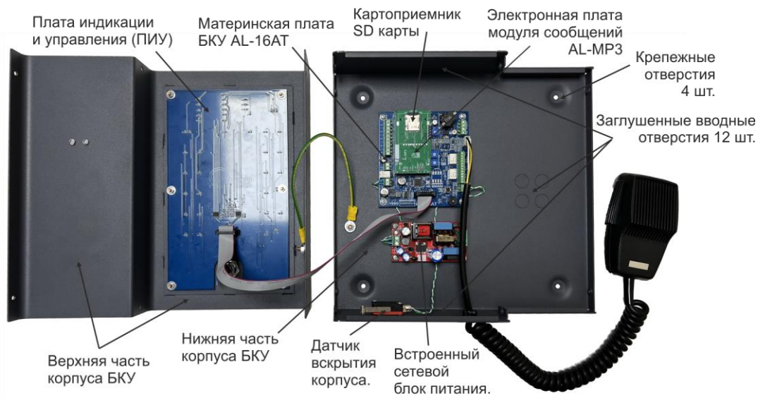
Рис. 5 (со снятой верхней частью корпуса)
